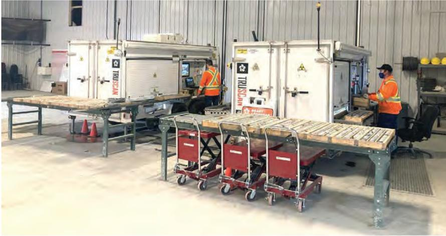
Fig 1: Unidades de escaneo de fluorescencia de rayos X de terreno operando en un galpón de testigos en Red Chris, British Columbia.
